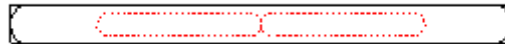
شکل ۲. چشمه ایریدیوم- ^{192}\text{Ir} شبیه‌سازی شده در این کار که درون استوانه‌ای جهت محاسبه شار خروجی اولیه از آن قرار داده شده است
