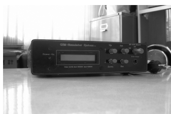
شکل ۲: دستگاه مولد امواج تلفن سیار (GSM)
