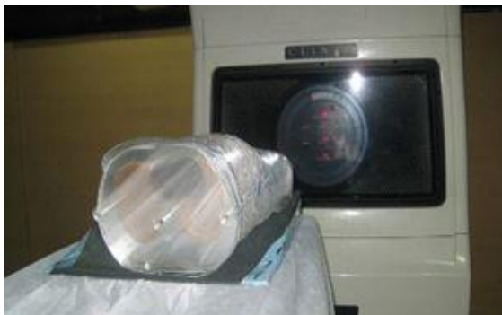
شکل ۲: نحوه قرارگیری فانتوم پستان کوچک جهت پرتو دهی
